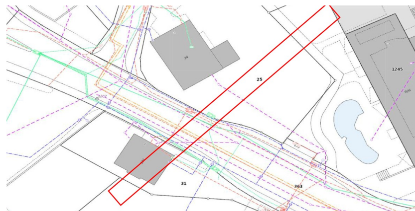
Abb. 22 : Theoretisch günstige Lage des Verbindungstunnels über Auszug Leitungskataster
